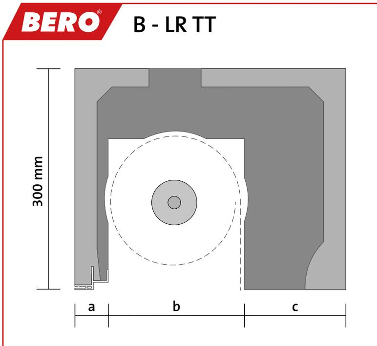
Selbsttragender Rollladenkasten aus bewehrtem BEROpor-Leichtbeton mit einer **äußeren Montageöffnung** für einen linksrollenden Rollladen.
