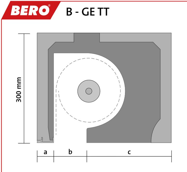
Selbsttragender Rollladenkasten aus bewehrtem BEROpor-Leichtbeton mit einer **äußeren Montageöffnung**.
