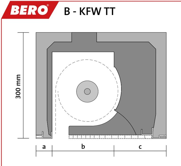
Selbsttragender Rollladenkasten aus bewehrtem BEROpor-Leichtbeton mit einer **inneren Montageöffnung**.
